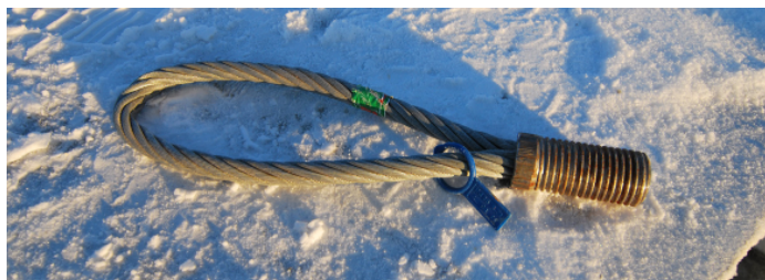
Kuva 21. Vaijerinostolenkki. Merkintälevykkeessä kierretyyppi ja -koko, sallittu kuorma ja valmistusvuosi.
